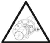
对于水平管道中的阀门安装,我们建议将阀门的轴安装在水平位置。请确保圆盘的下边缘与水流方向一致。这样可以防止泥浆沉积并损坏轴密封区域(图2)
