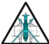
法兰面必须光滑干净。须清除铁锈、焊接划痕、油漆残留物、污垢等,以防损坏阀门密封面。(图5)
